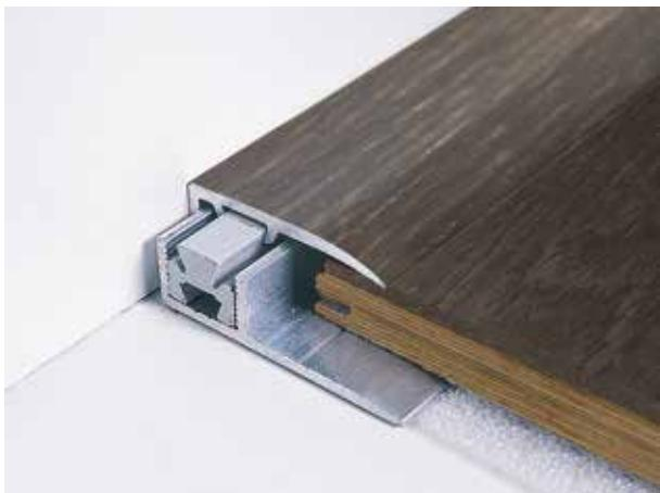
Profilo brevettato per bordare perimetralmente pavimenti che necessitano di dilatazione perché, grazie alla cavità interna di 16 mm, consente un movimento dei pavimenti sottostanti di oltre  $\pm 5$  mm. Evita l'uso del battiscopa, garantendo la dilatazione ed il fissaggio perimetrale del pavimento. Utilizzabile anche come delimitazione di bussole per zerbini e in corrispondenza di porte scorrevoli.
